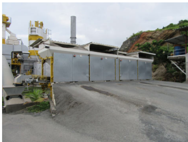
Racks de stockage des granulats (à gauche) et trémies de prédosage (à droite)
